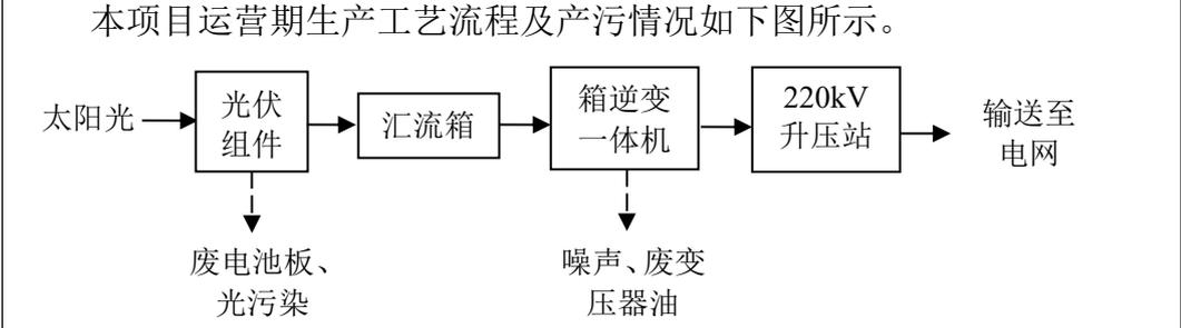
**图 4-1 项目运营期工艺流程及排污产点示意图**
